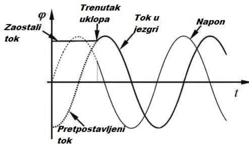
Slika 3.24. Idealni trenutak uklopa transformatora u praznom hodu [5]
