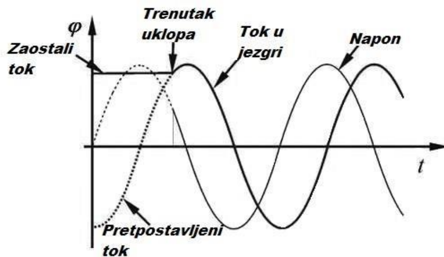
Slika 3.24. Idealni trenutak uklopa transformatora u praznom hodu [5]
