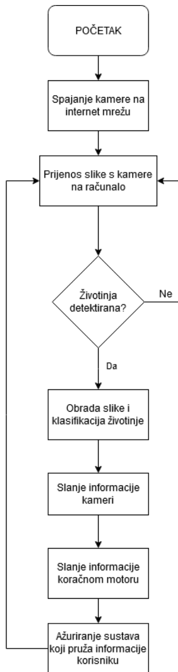
Slika 2.5. Zamišljeni blok dijagram programskog rješenja.
