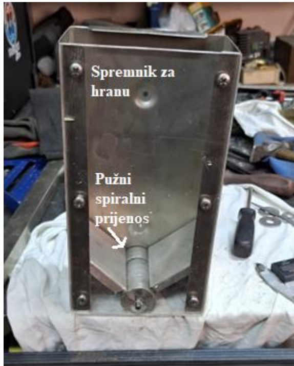
Slika 3.5. Prva verzija kućišta hranilice.
