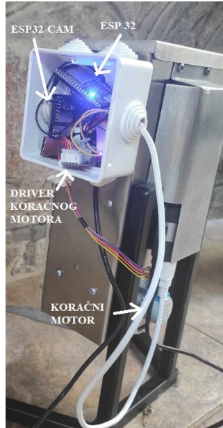
Slika 3.8. Komponente ugrađene na hranilicu.
