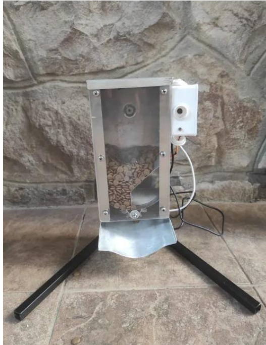
Slika 3.9. Konačna verzija konstrukcijskog rješenja hranilice.
