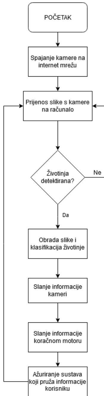
Slika 2.5. Zamišljeni blok dijagram programskog rješenja.
