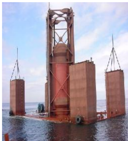
Slika 2.2.4. Archimedes Wave Swing kojeg je razvila tvrtka AWS Ocean Energy Ltd. [10]
