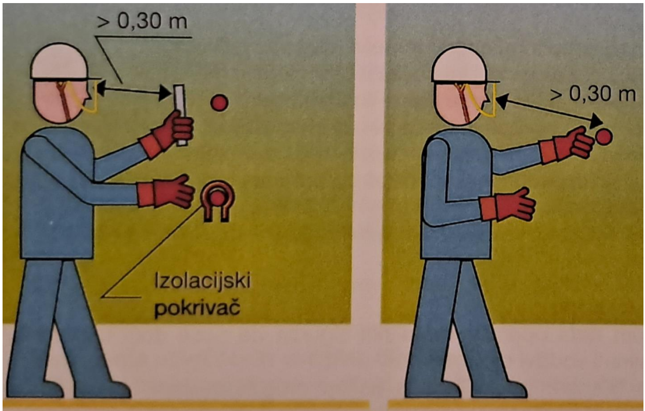
Slika 4.5 Grafički prikaz metoda rada u dodiru gdje su jasno vidljivi sigurnosni razmaci [17]
