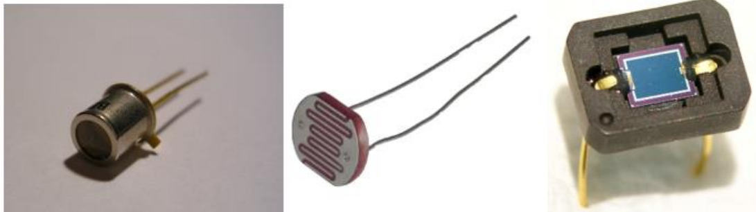
Slika 2.2. Prikaz fototranzistora, fotootpornika i fotodiode
