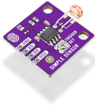
Slika 3.1. Fotootpornik koji se koristi u izradi
