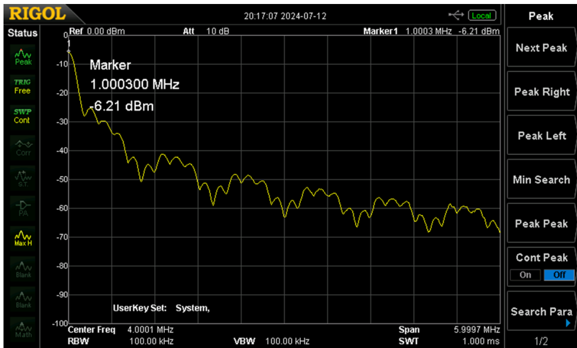
Slika 4.6. Prikaz frekvencijskog spektra QASK moduliranog signala na spektralnom analizatoru.
