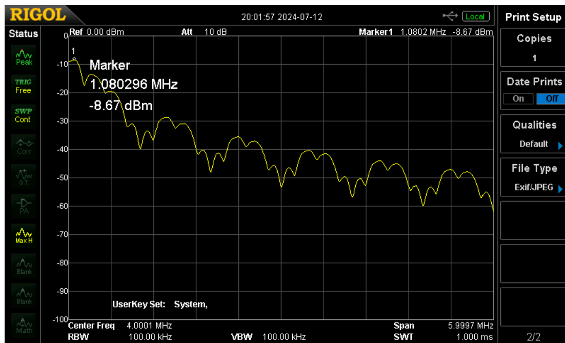
Slika 4.2. Prikaz frekvencijskog spektra BPSK moduliranog signala na spektralnom analizatoru.
