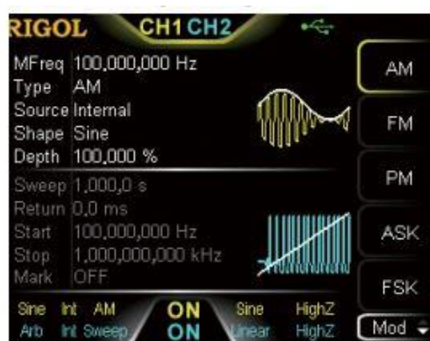
Slika 2.7. Prikaz ugrađenih modulacijskih postupaka funkcijskog generatora.
