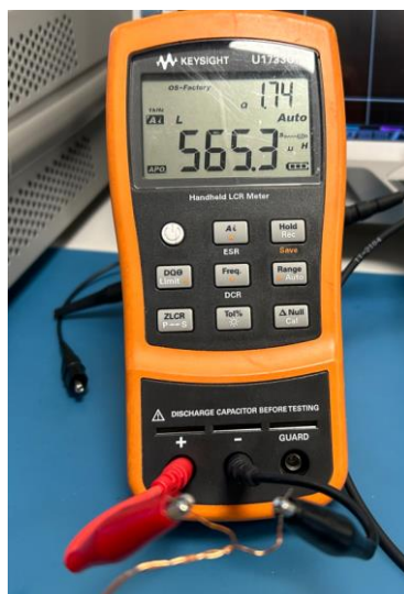
Sl. 5-1 Mjerenje induktiviteta PI zavojnice RLC-metrom
