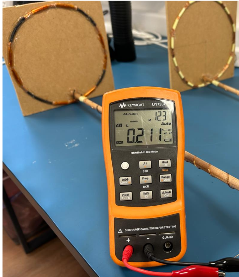
Sl. 4-3 Mjerenje induktiviteta BFO zavojnice RLC-metrom
