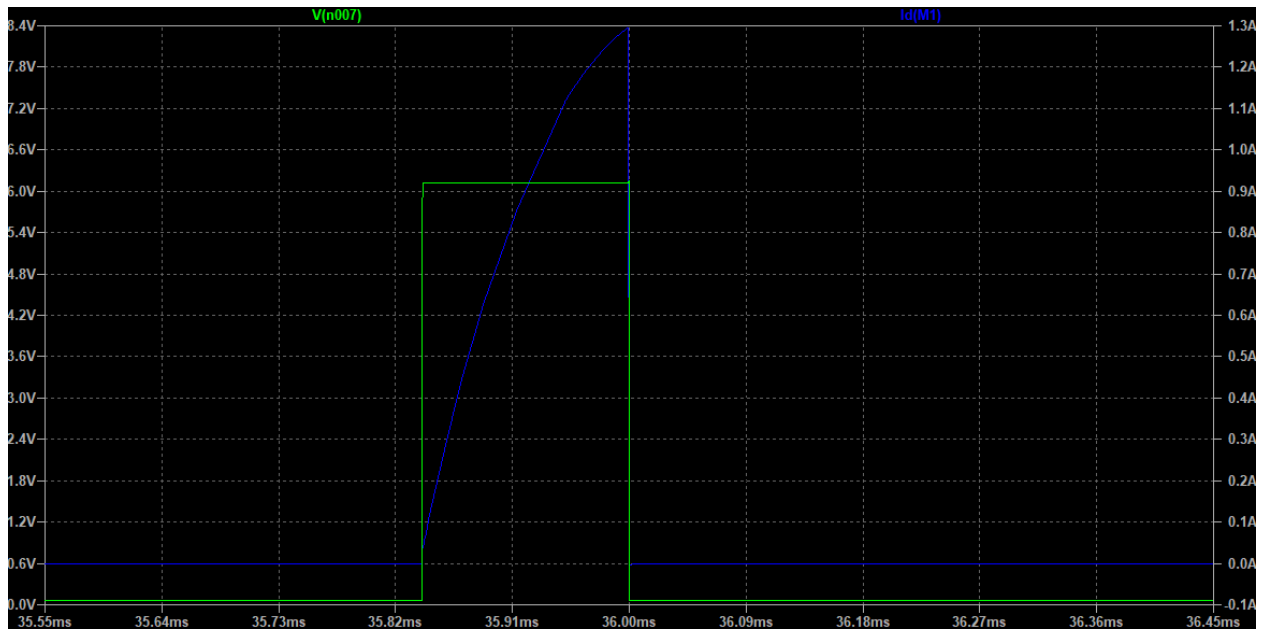
Sl. 3-6 Porast struje kroz zavojnicu L prilikom zatvaranja MOSFET-a
