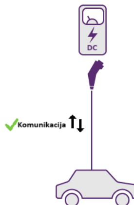
Slika 4.11. Način 4 - punjenje pomoću javne punionice, istosmjerna struja [38]
