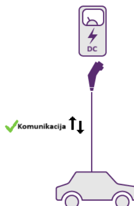
Slika 4.11. Način 4 - punjenje pomoću javne punionice, istosmjerna struja [38]
