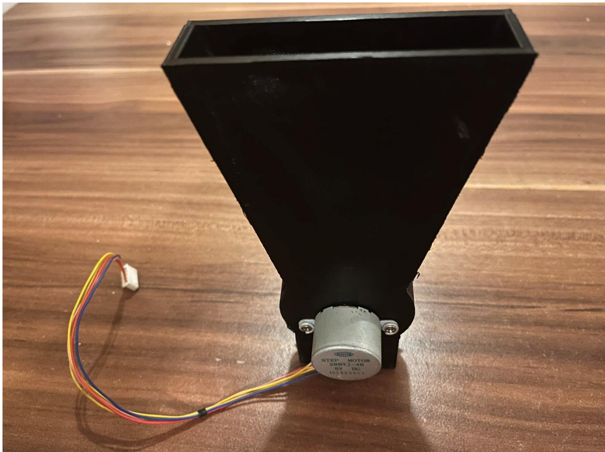
Slika 4.5. Prikaz 3D isprintanog modela hranilice sa stepper motorom
