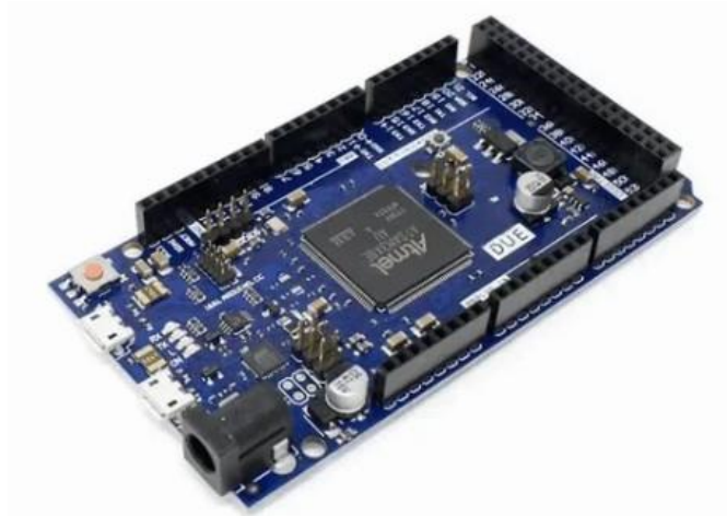
Slika 2.7. Pločica sa ARM Cortex-M3 procesorom [34]
