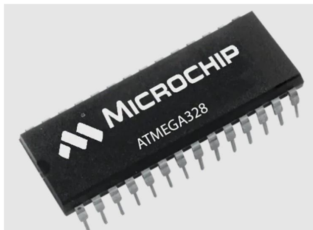
Slika 2.8. 8 bitni AVR procesor [35]
