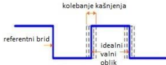
Slika 2.2. Prikaz kolebanja izlaznog signala oscilatora [2]
