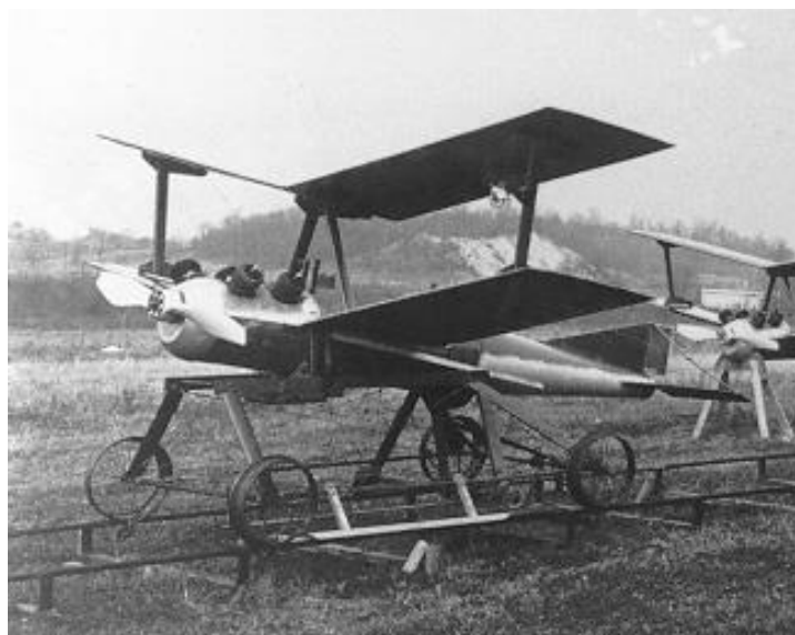
Slika 2.1. Prva verzije bespilotne letjelice „Kettering Bug”
