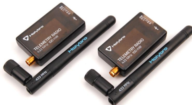
Slika 4.8. Holybro SiK V3 telemetrijski radio
