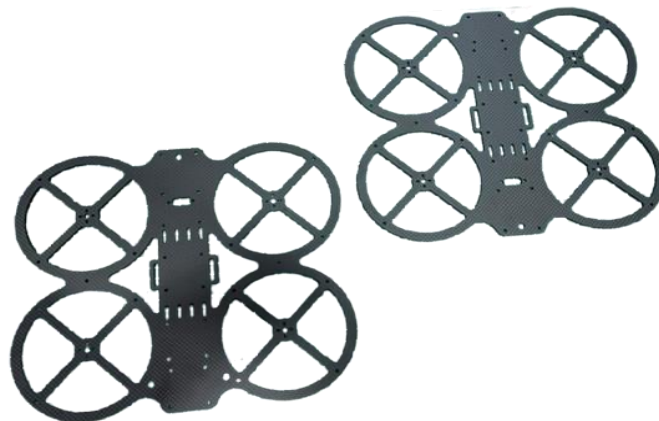
Slika 4.2. Okvir drona koji se koristi u radu
