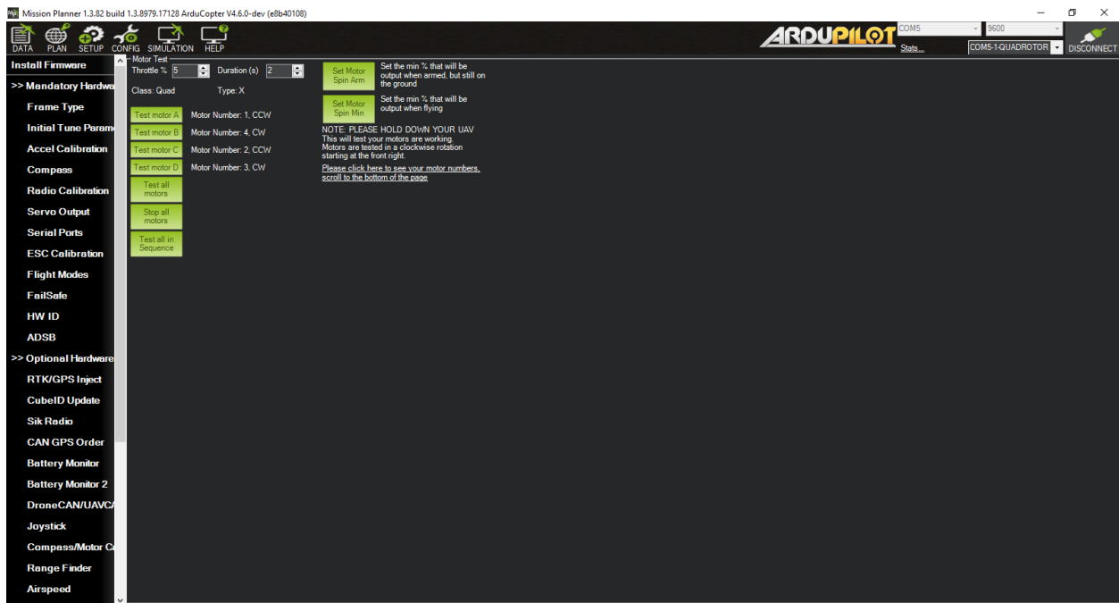
Slika 5.4. Prikaz testiranja rada motora u Mission Planner-u
