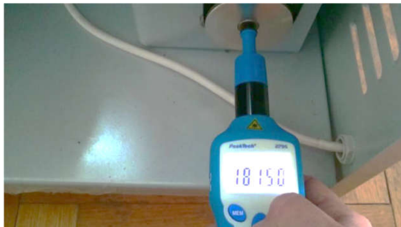
Slika 4.3.: Digitalni tahometar Peak Tech 2795 .
