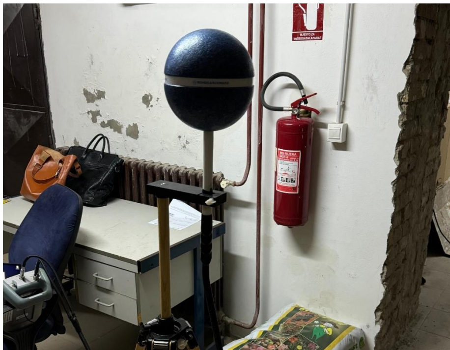
Slika 4.3 Prijemna izotropna antena R&S TS-EMF sustava
