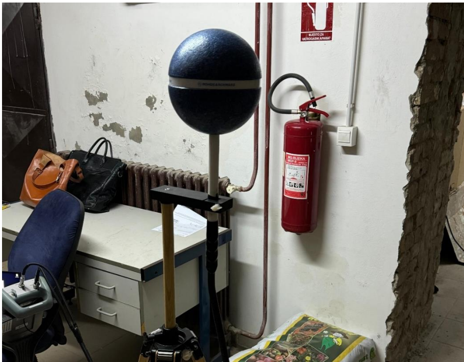
Slika 4.3 Prijemna izotropna antena R&S TS-EMF sustava
