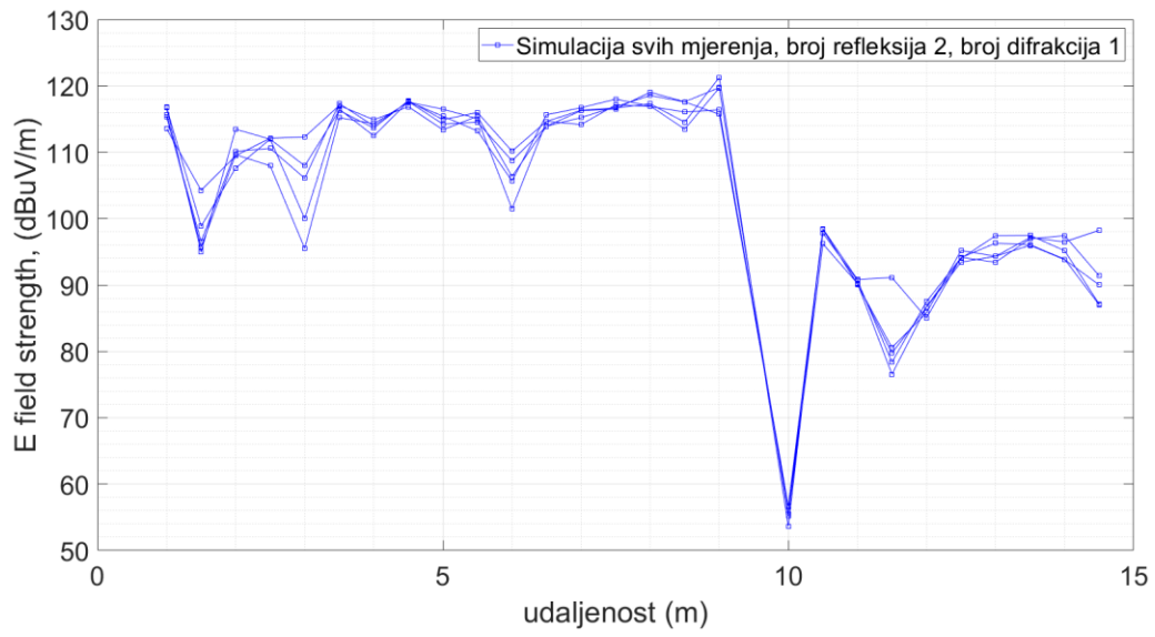
Slika P.1. 5 Rezultati simulacije za 2 refleksije i 1 difrakciju na frekvenciji 860 MHz
