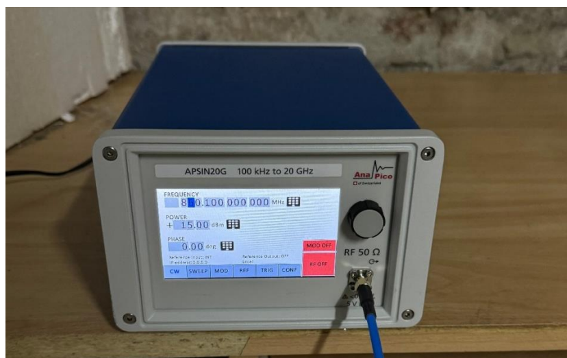
Slika 4.1 Generator signala ANAPICO ASPIN20G
