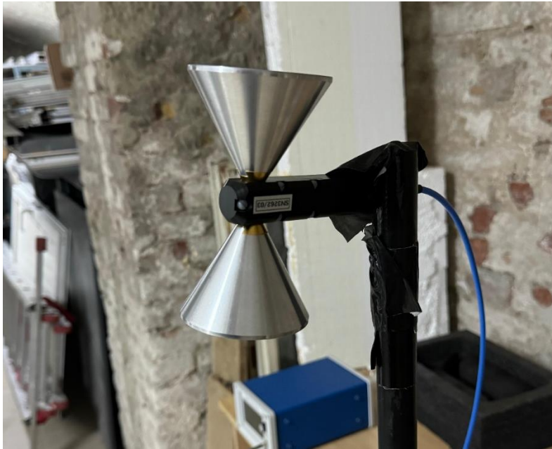
Slika 4.2 Odašiljačka antena PCD 8250
