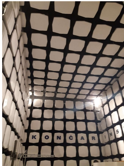
Slika 6.1. Prikaz RF apsorbera unutar komore
