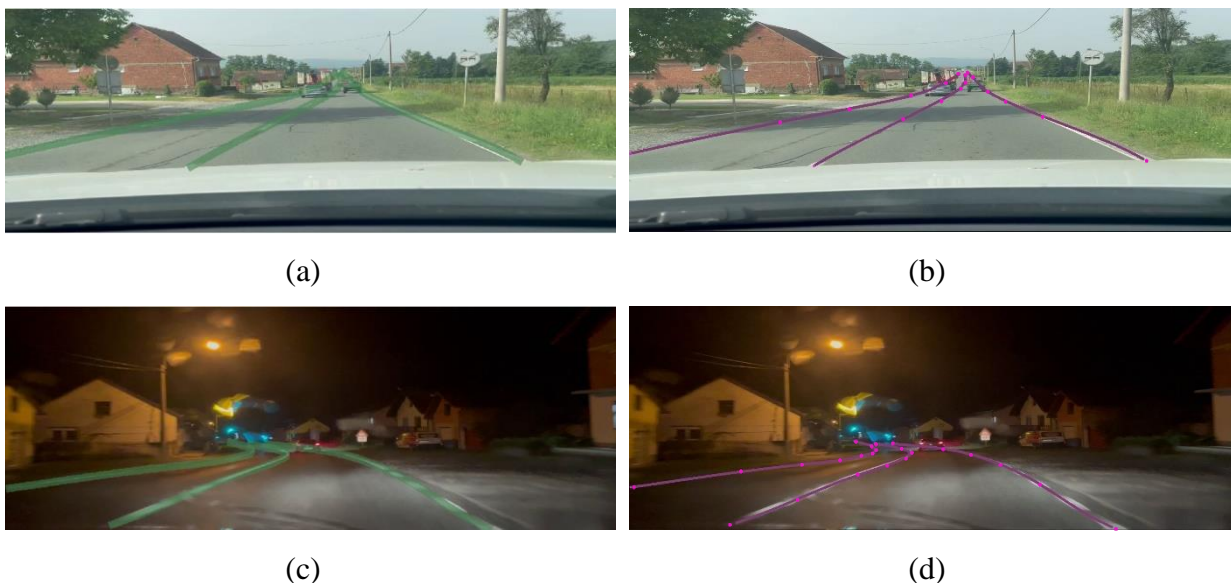
Slika 4.3 Prikaz načina testiranja aplikacije (a) primjer jedne označene slike unutar aplikacije (b) primjer testiranja zapisani koordinata nakon označavanja (a) slike (c) primjer druge označene slike unutar aplikacije (d) primjer testiranja zapisani koordinata nakon označavanja (c) slike
