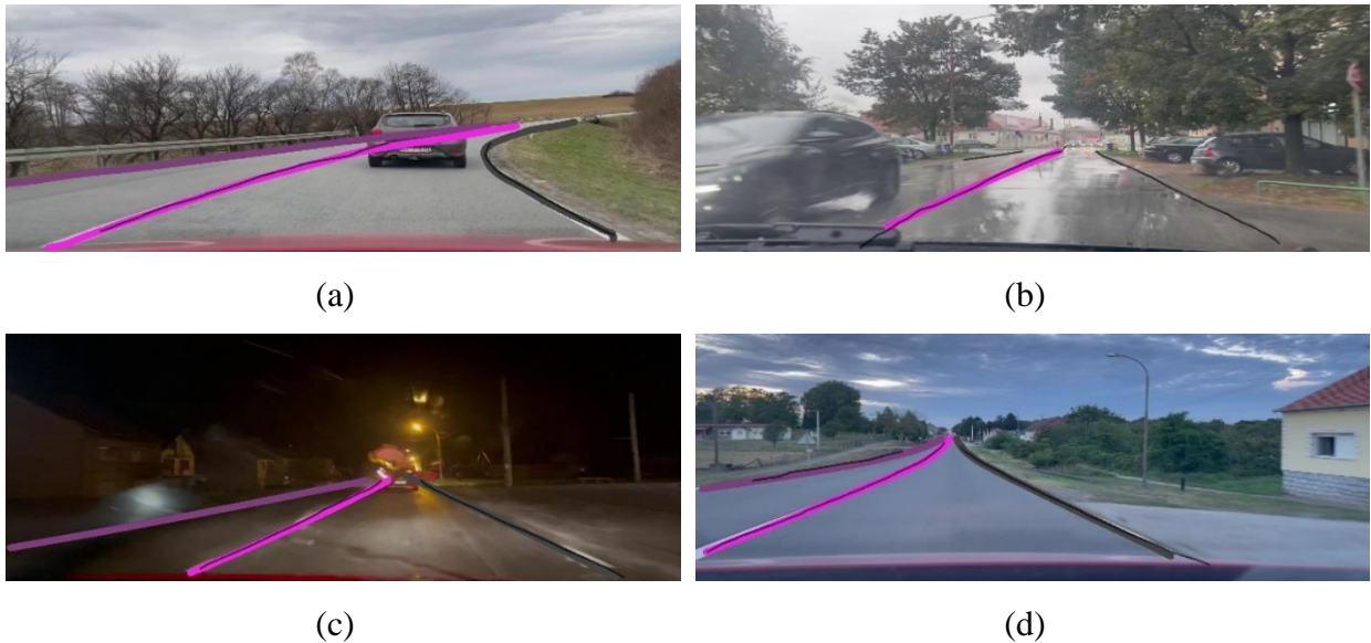
Slika 4.27 Prikaz predviđenih linija SCNN-ERFNET modela treniranog na TuSimple podatkovnom skupu i testiranog na novokreiranom skupu podataka (a) ruralno područje, krivina, djelomična naoblaka, auto zaklanja liniju (b) loša vidljivost, kišni dan, slaba vidljivost jedine linije (c) noćna vožnja po kiši, slaba vidljivost kroz vjetrobransko staklo, mutna slika (d) ravna cesta bez prometa, jako dobra vidljivost, sumrak
