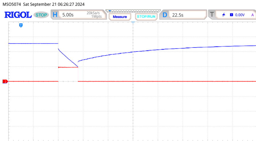
Slika 7.7. Valni oblik napona na priključcima (terminalima) pasivnog HBSS-a prikazan je plavom bojom, a valni oblik struje tereta izmjeren na otporniku R_s prikazan je crvenom bojom. Vršna vrijednost struje pulsa iznosi I_p = 20 A
