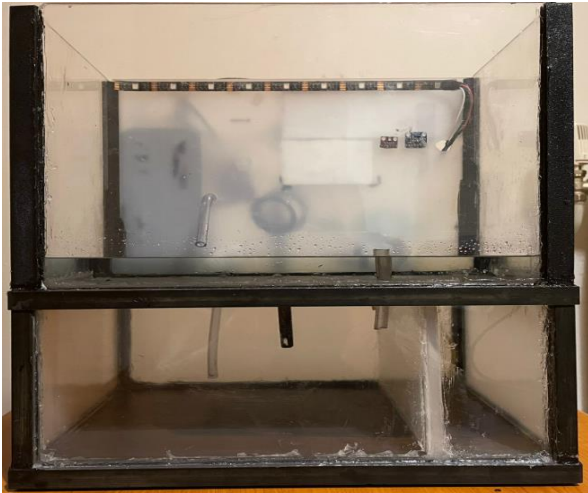
Slika 4.3. Test vodonepropusnosti gornjeg dijela konstrukcije
