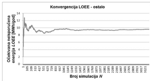
Slika P. 19. Konvergencija očekivane neisporučene energije zbog ostalih zastoja
