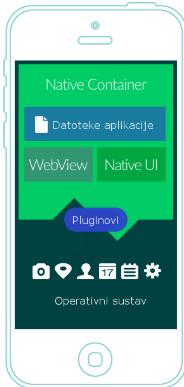
Slika 3.1. Shematski prikaz hibridne aplikacije (izvor: ionicframework.com)
