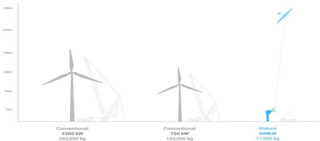
Sl. 3.5. Tipovi vjetroagregata po visini, snazi i promjeru rotora
