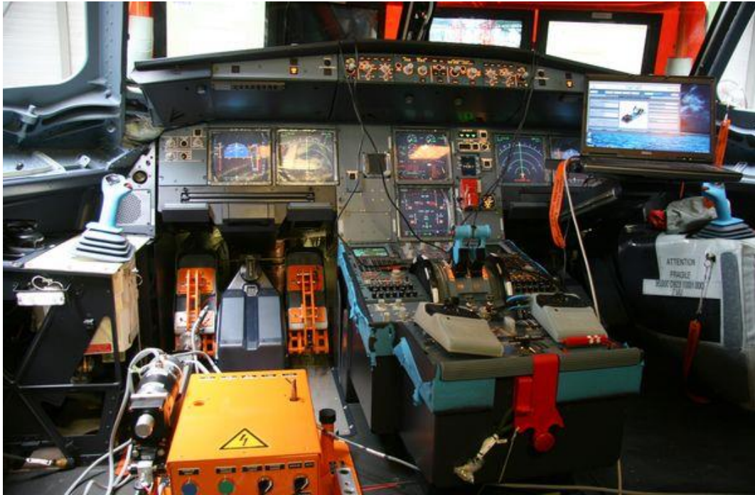
Slika 6.4. Mjerenje sile pritiska na papučice u zrakoplovu
