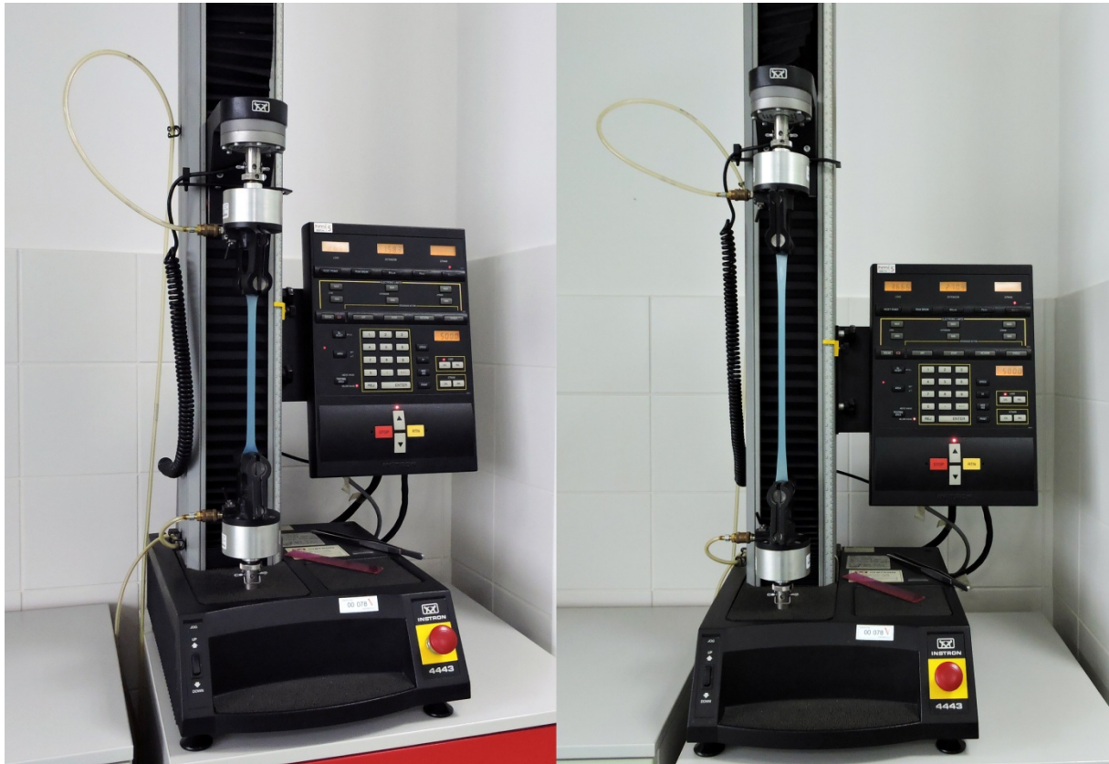
Slika 3.5.4.1. Ispitivanje na kidanje (vlačno ispitivanje) VpCI – 126 folije na Instron 4443 kidalici, [28].
