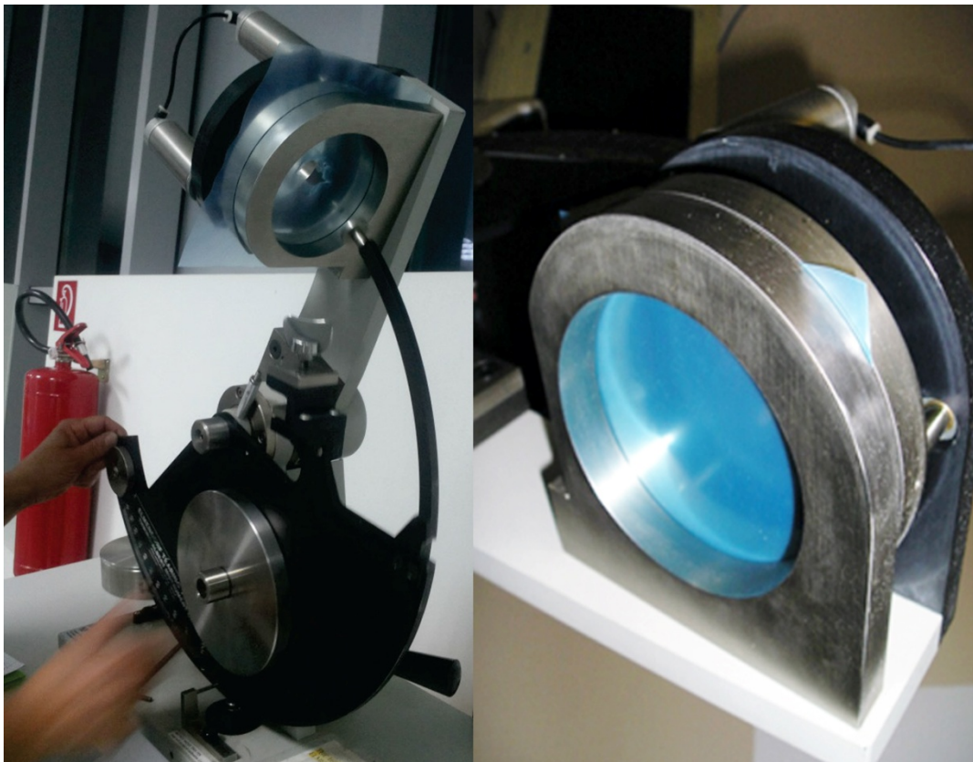
Slika 3.5.3.1. Test probijanja VpCI – 126 folije, [29].
