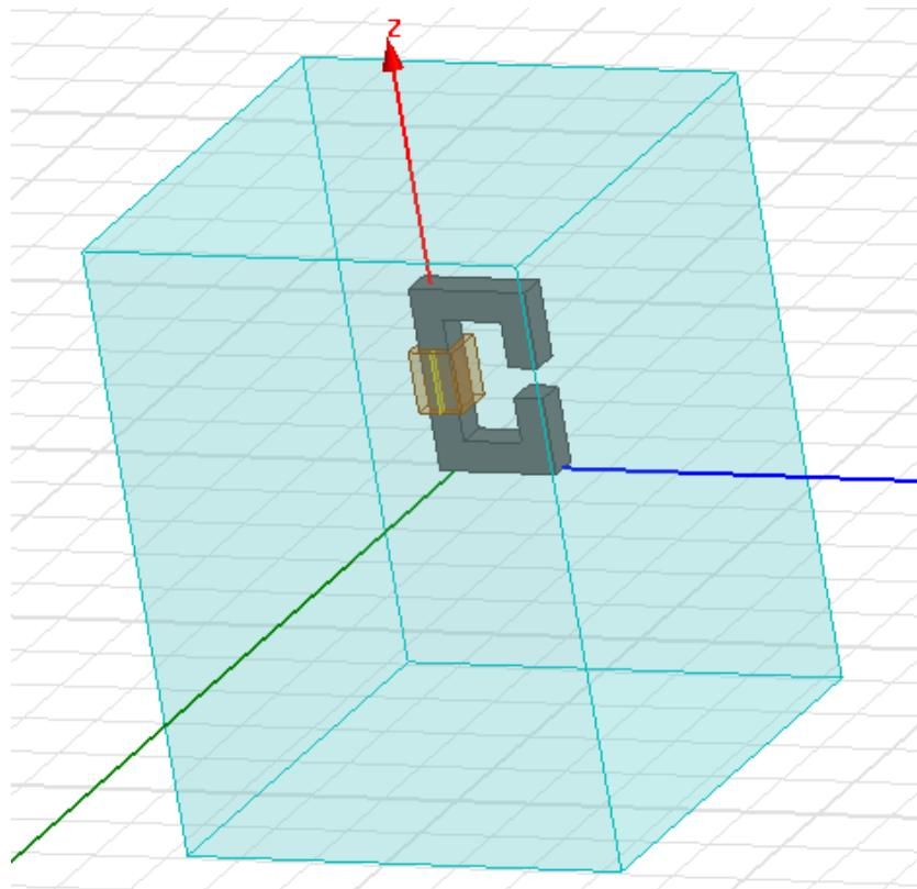
Za proračun magnetskog toka korištenjem programskog kalkulatora *Maxwell Calculator* potrebno je odrediti površine za koje želimo izračunati magnetski tok.
