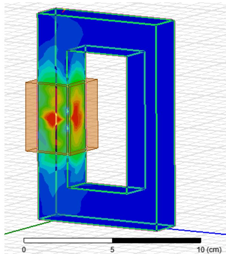
Za određivanje nastalog zagrijavanja jezgre i namota potrebno je nastalu simulaciju otvoriti u Ansys Workbench-u klikom na *Import* te zatim na *Update Project*.
