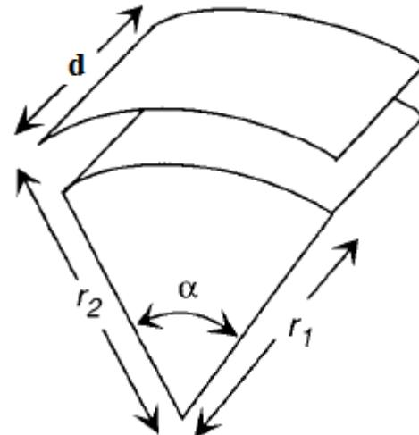
**Slika 2.29.** Element s zračnim rasporom (isječak prstena)
