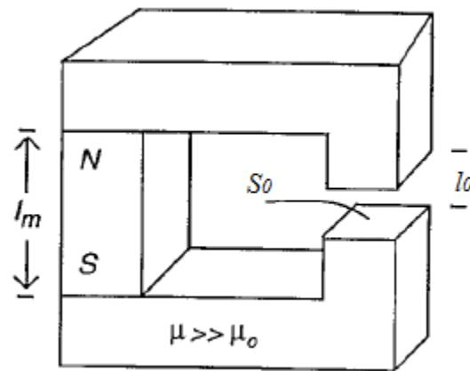
**Slika 2.32.** Složeni magnetski krug s permanentnim magnetom
