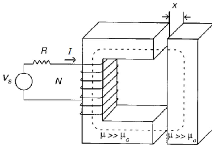
**Slika 2.31.** Složeni magnetski krug s dva zračna raspora
