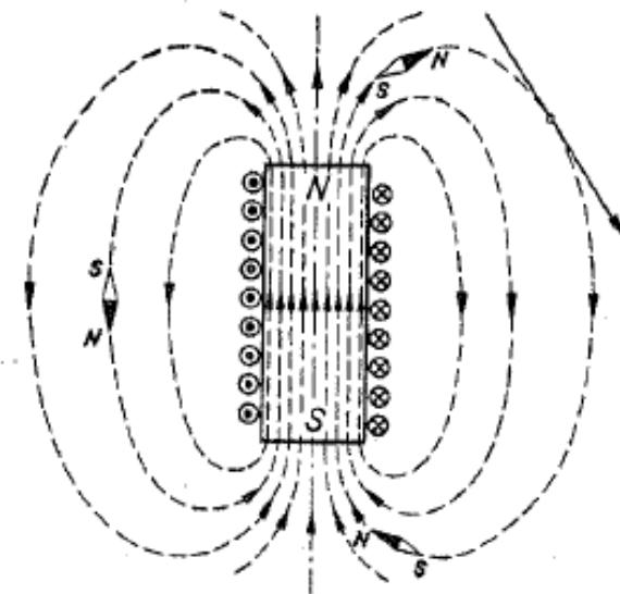
**Slika 2.3.** Smjer magnetskih silnica
