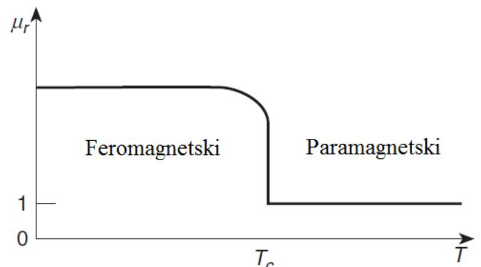
**Slika 2.10.** Relativna permeabilnost kao funkcija temperature za feromagnetike
