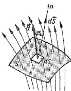
**Slika 2.4.** Prikaz magnetskih silnica kroz neku površinu
