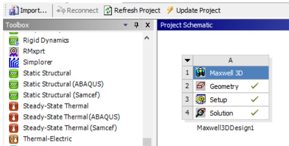
Zatim je potrebno spojiti našu *Geometry* s *Steady-State Thermal Analysis System*, tako što prevučemo ikonu *Steady-State Thermal* na *Geometry*.
