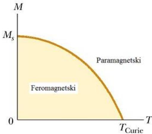
**Slika 2.9.** Intenzitet magnetizacije kao funkcija temperature za feromagnetike
