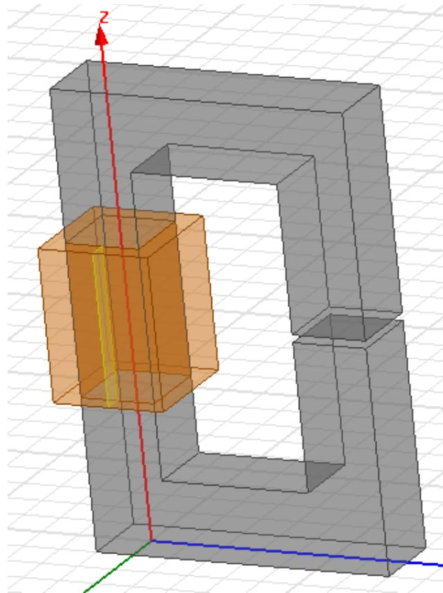
**Slika 3.15.** Jezgra s rasporom i elektromagnetom
