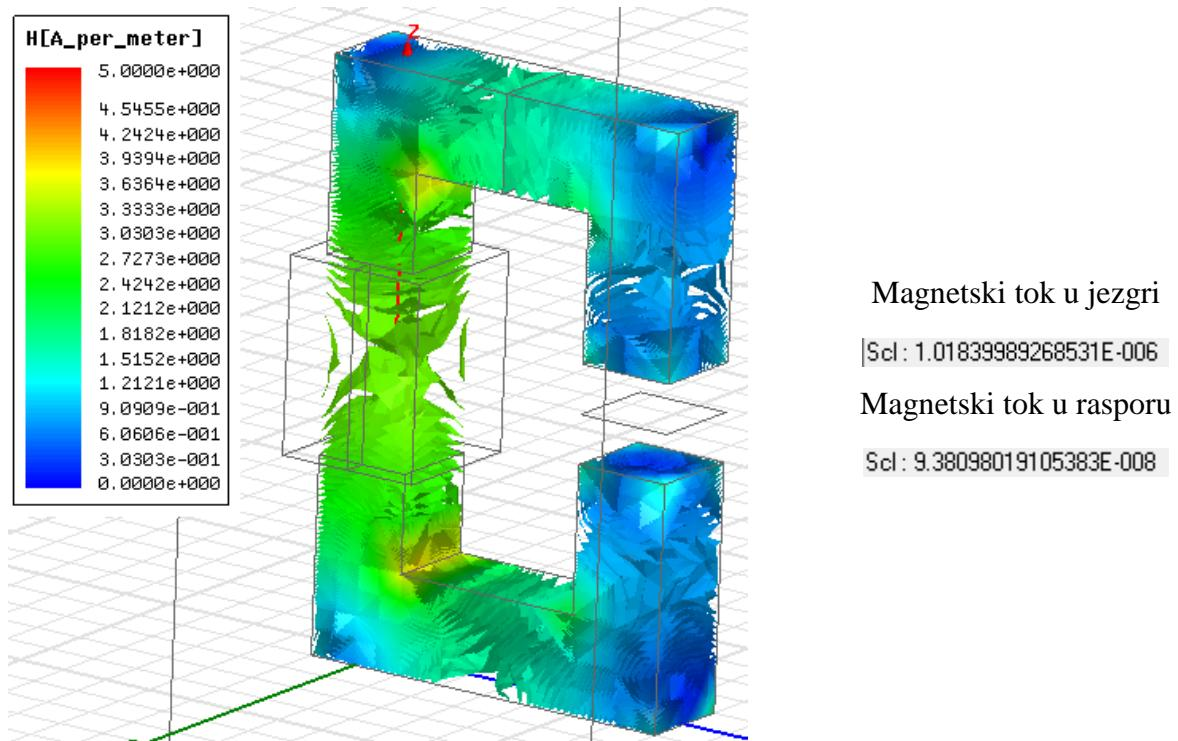
**Slika 4.7.** Prikaz jakosti magnetskog polja unutar jezgre s elektromagnetom i strujom 5 A
