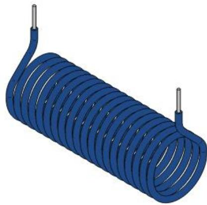
**Slika 2.2.** Elektromagnet
