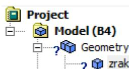
Ispod *Project* otvara se prozor s detaljima vezanim s geometrijom. Žutom bojom označena polja moraju biti definirana. Klikom na strelicu otvara se prozorčić u kojem možemo izabrati željeni materijal. Postupak ponovimo za svaki dio geometrije.
