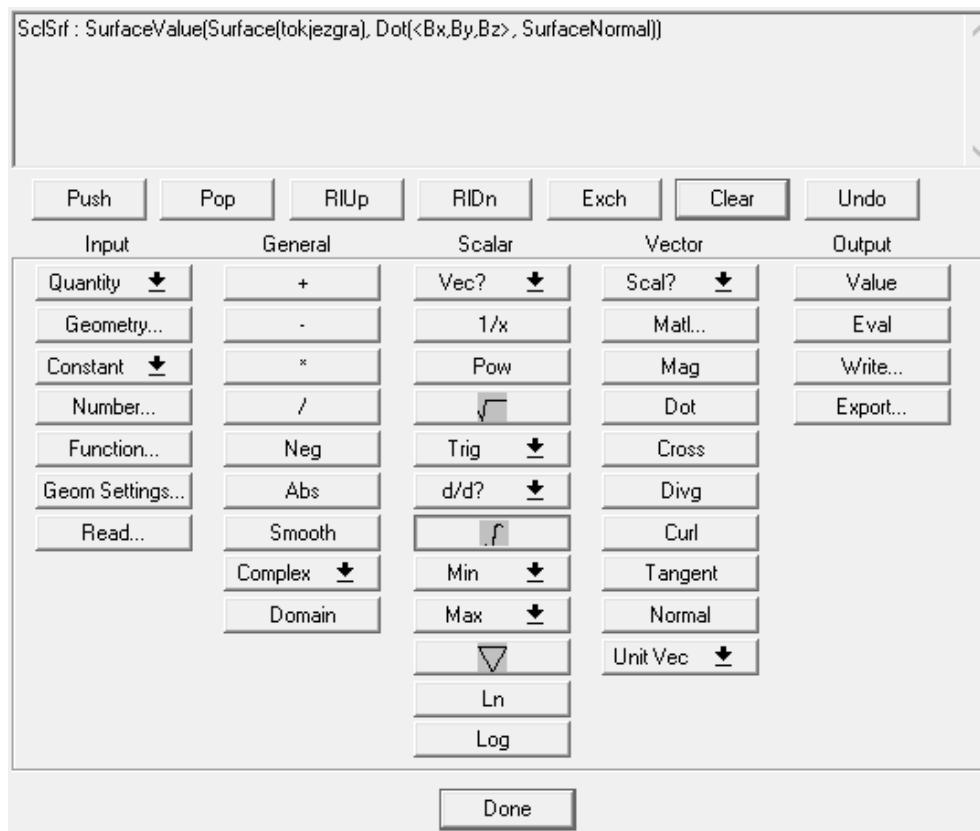
Klikom na *Eval* na kalkulatoru se ispisuje rješenje točnije magnetski tok.
