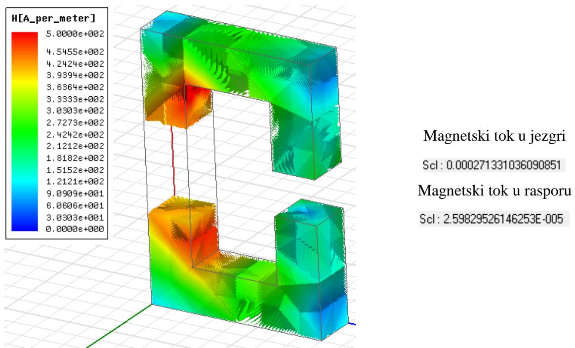
**Slika 4.6.** Prikaz jakosti magnetskog polja unutar jezgre s alnico permanentnim magnetom
