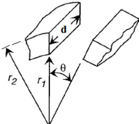
**Slika 2.28.** Element s zračnim rasporom (isječak prstena)
