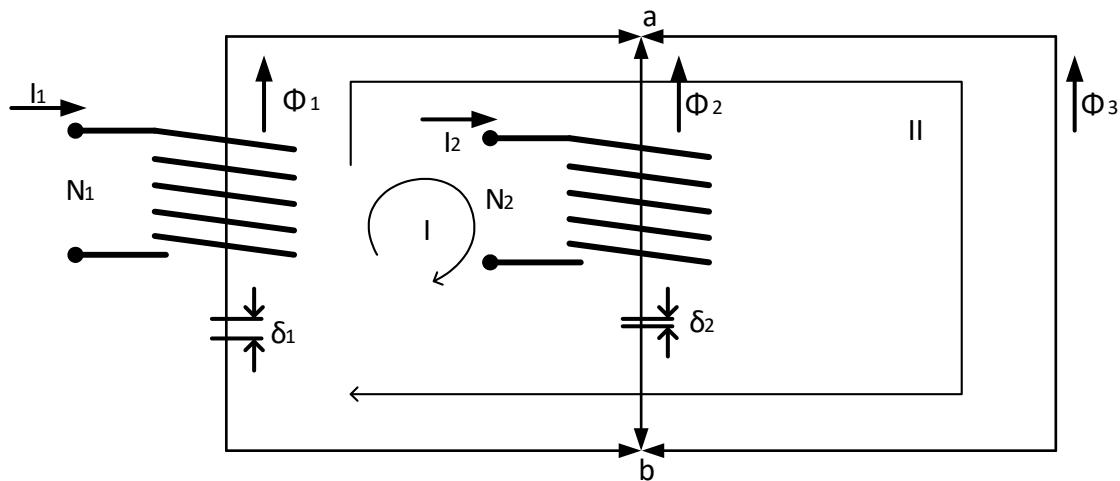
**Slika 3.4.** Graf magnetskog kruga s označenim prepostavljenim smjerovima magnetskih tokova
