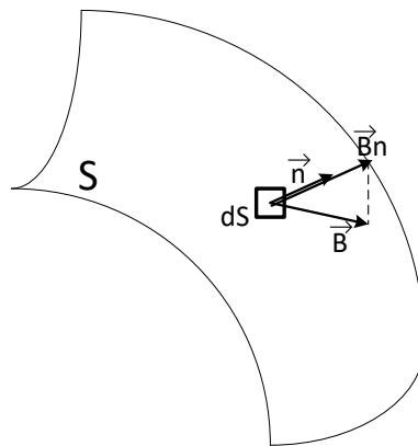
**Slika 3.1.** Magnetski tok kroz neku površinu  $S$
