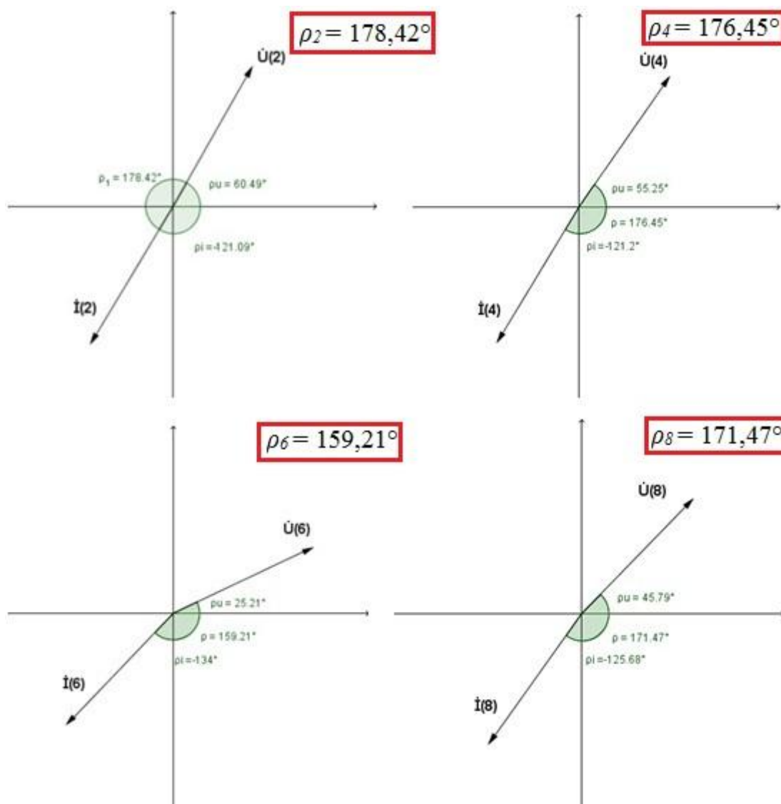
Slika 3.4. Fazni pomak između napona i struje za harmonike: 2,4,6,8, gdje je snaga kuteva negativna, \rho(n) > 90^\circ, P(n) < 0 .
