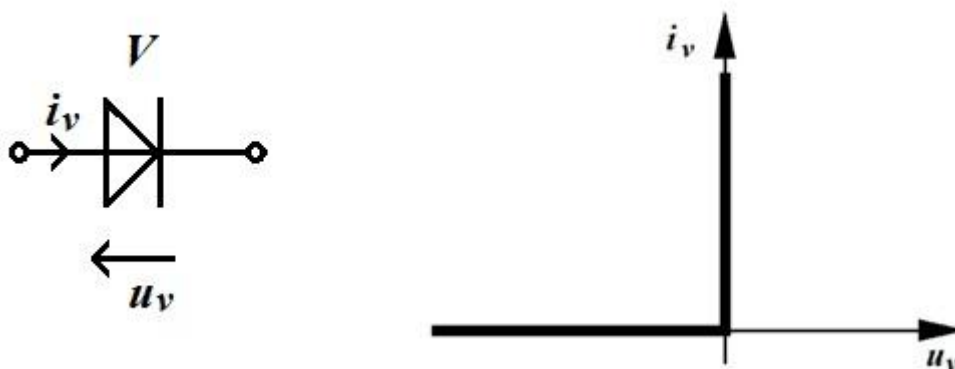
Slika 3.2. Simbol i karakteristika neupravljive sklopke (idealne diode)[2].
