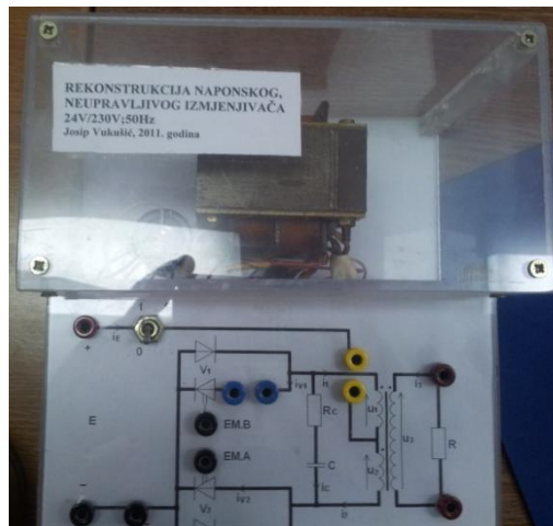
Slika 3.12. Korištena maketa naponskog, neupravljivog izmjenjivača u mjeranju.
