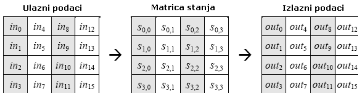
Slika 4.7 Ulazno/izlazni podaci te matrica stanja (izvor: http://sigurnost.zemris.fer.hr/ns/wireless )
