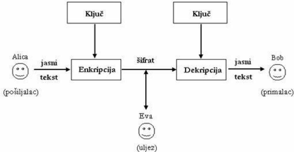
Slika 4.1 Shematski prikaz simetričnog sustava (izvor:
