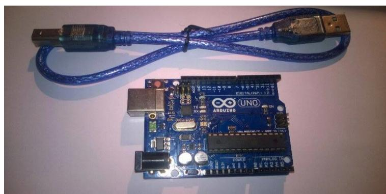
Slika 3.1. - Arduino UNO sa mikrokontrolerom ATMEGA328P i USB kabalom
