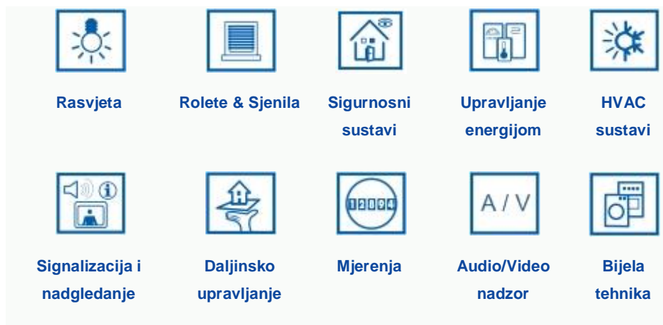
Slika 2.5. - Sustavi upravljani KNX-om
