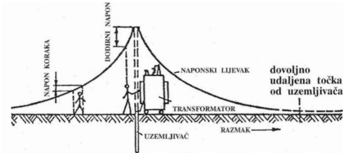
Slika 2.1) Razdioba potencija oko uzemljivača [2]
