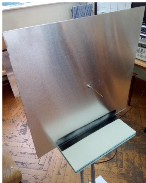
Slika 3.21. Odašiljačka unipol antena za 900 MHz na stalku prilikom mjerenja dijagrama zračenja u E ravnini
