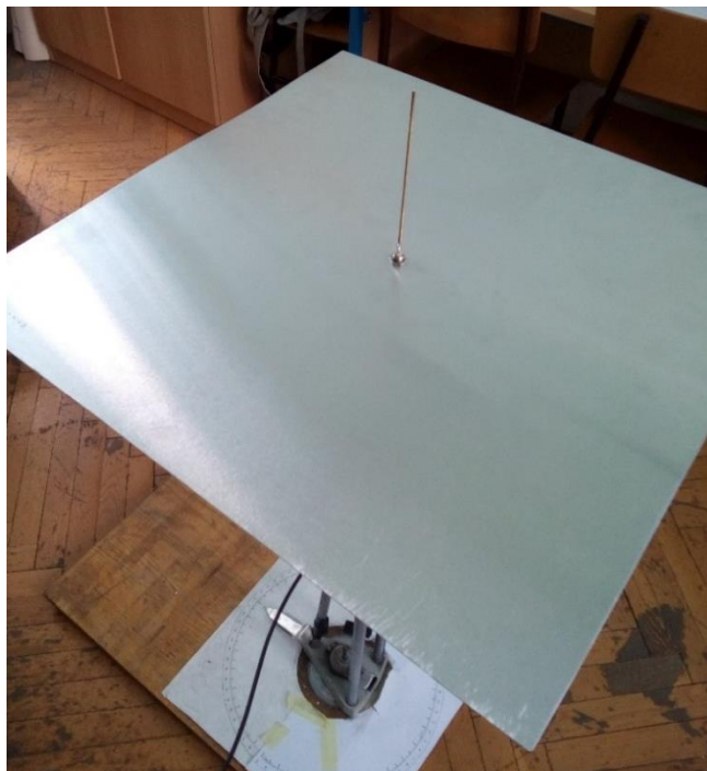
Slika 3.1. Laboratorijski model unipol antene za centralnu frekvenciju 500 MHz
