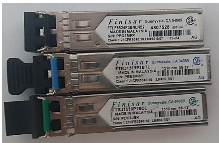
Slika 4.25 Prikaz korištenih SFP modula (I, II i III prozor)
