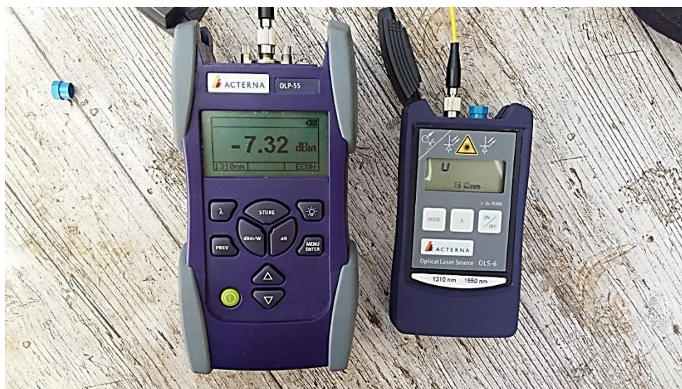
Slika 4.16 Mjerni instrumenti OLP-55 i OLS6
