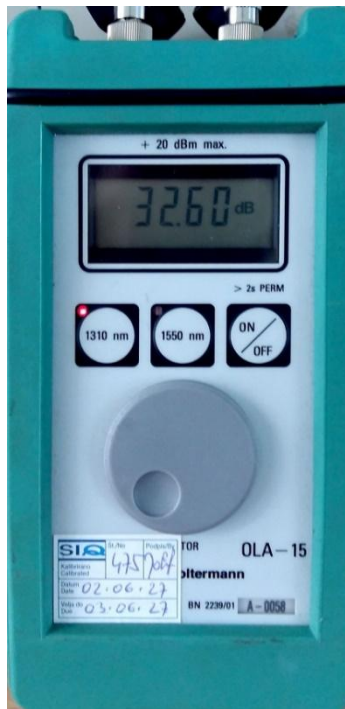
Slika 4.21 Mjerni instrument OLA-15
