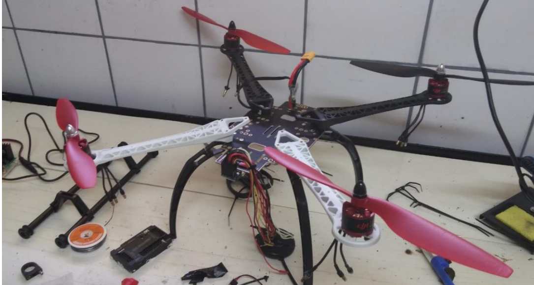
Slika 10.1. Montiranje motora na letjelici
