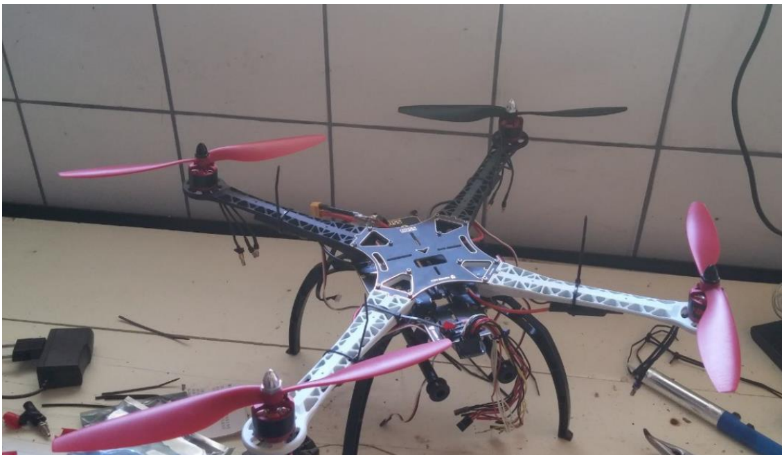
Slika 10.2. Montiranje poklopca na središnjem dijelu letjelice
