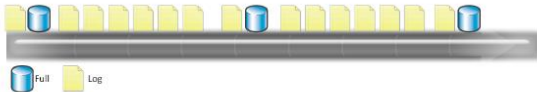
Sl. 2.6.: Raspored izrade potpune sigurnosne kopije podataka i zapisa izvršenih promjena [5]
