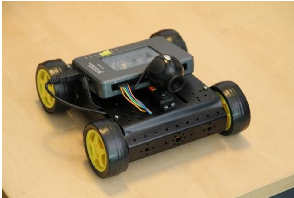
Slika 3.7. Prikaz robota s kamerom i NI myRIO uređajem [12]
