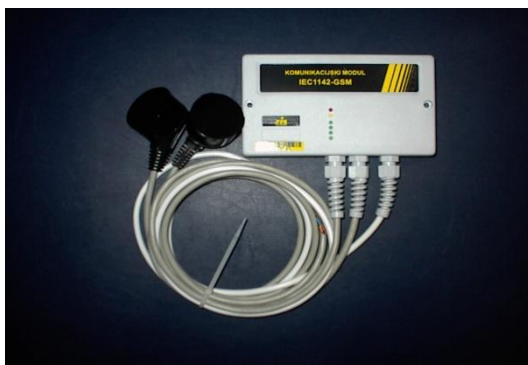
Sl. 4. Komunikacijski GSM modul IEC 1142 proizvođača Riz Zagreb Omogućuje programiranje i očitavanje jednog ili grupe mjernih uređaja putem magnetske sonde i priključne kutije PK-100
