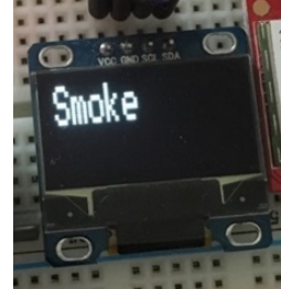
Sl. PD.10. Ispis zaslona pri odabiru plina 5, odnosno očitavanje dima u zraku.
