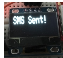
Sl. PD.14. Ispis zaslona nakon slanja SMS poruke.
