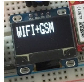
Sl. PD.2. Prikaz zaslona kada se odabere način rada 1, odnosno slanje informacija putem WiFi i GSM veze.
