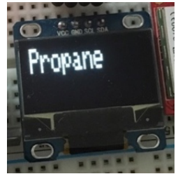
Sl. PD.11. Ispis zaslona pri odabiru tipa plina 6, odnosno očitavanje propana u zraku.
