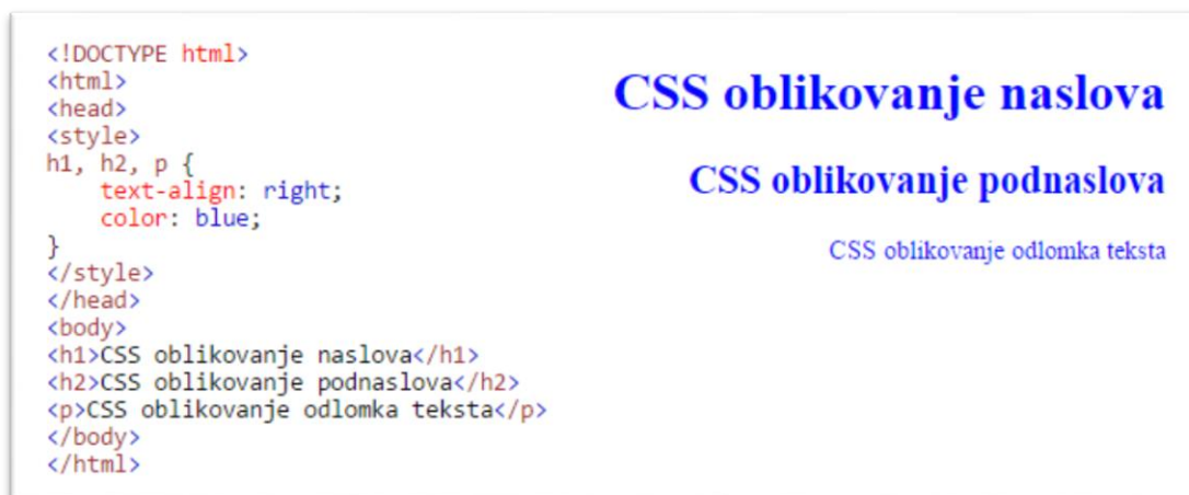
Slika 2.2. Primjer CSS oblikovanja internet stranice: program (lijevo); izgled stranice (desno).
