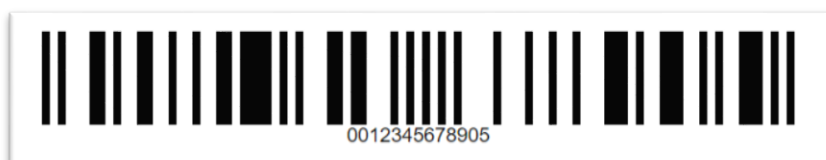
Slika 2.6. EAN-13 barkod niza 001234567890, s izračunatim zaštitnim znakom 5.
