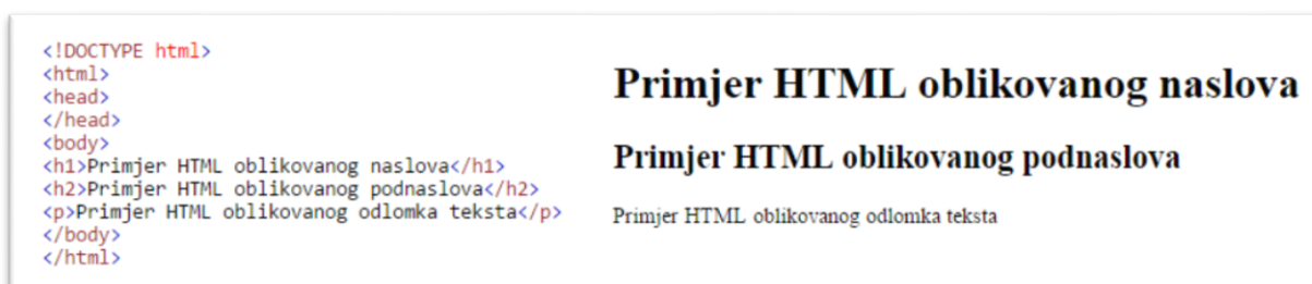
Slika 2.1. Primjer HTML oblikovanja internet stranice: HTML (lijevo); izgled (desno).
