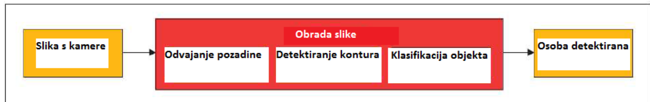
Sl.4.8. SWEETcam algoritam za detekciju objekata [5]
