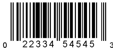
Slika 2.1 Primjer UPC-A bar koda
