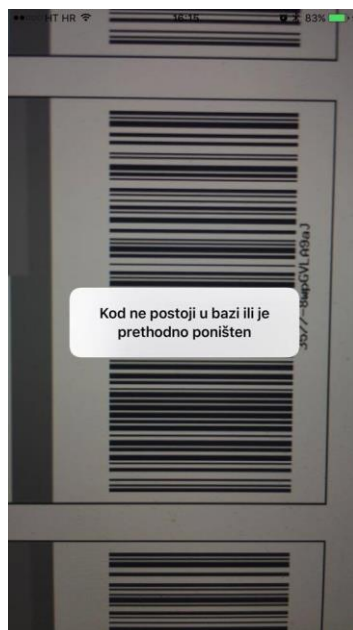
Slika 5.2 Primjer neuspješno očitano bar koda tipa Code 93
