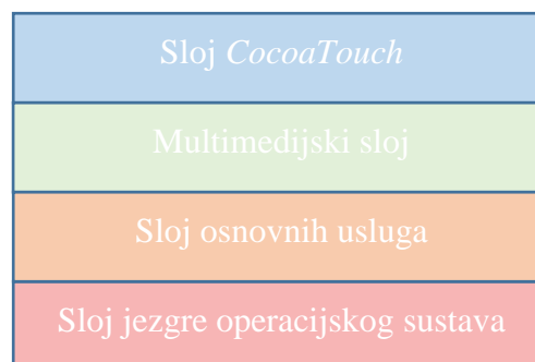
Slika 3.1 Slojevi iOS platforme
