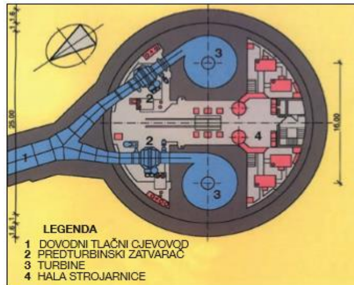
Slika 4.10. Pogled na halu strojarnice (od gore)
