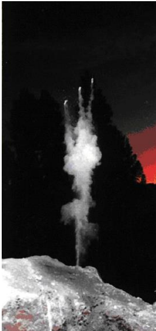
Slika 4.14. Izbacivanje smjese zbog razlike temperature
