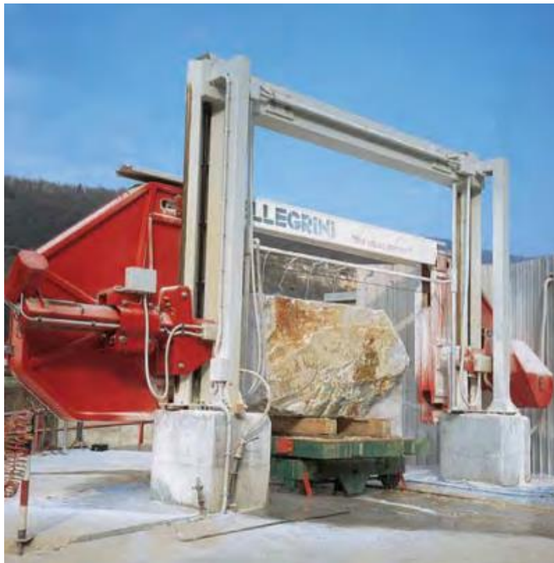
Slika 5.14. Filo sajla za rezanje kamena
