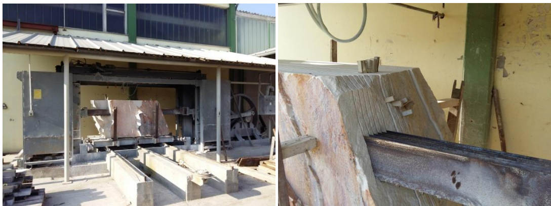
Slika4.17. Mali gater; pile malog gatera
