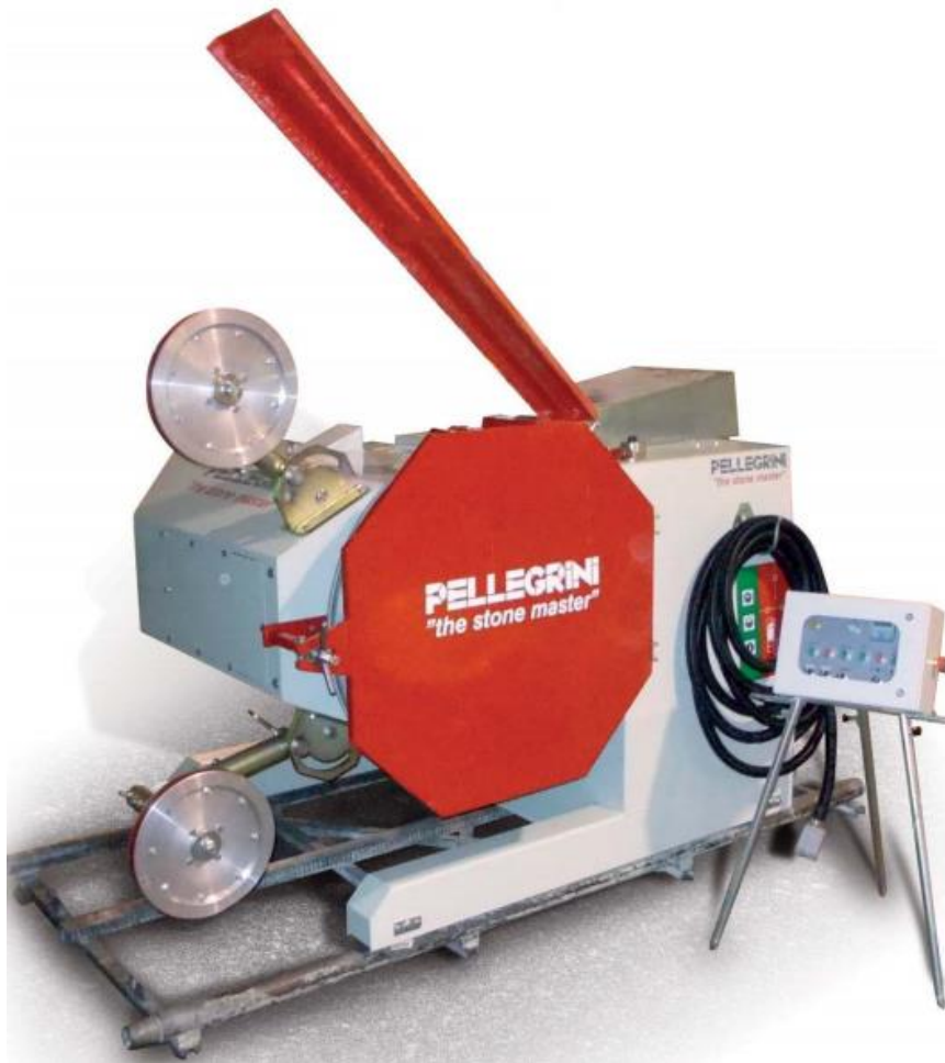
Slika 5.10. Dijamantna žična pila tvrtke Pellegrini
