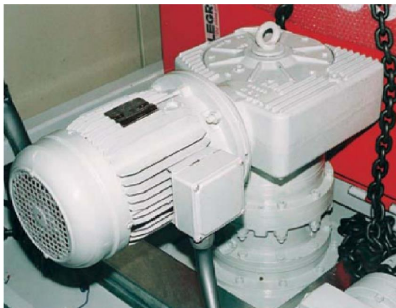
Slika 5.6. Motor za pomicanje sjekačice po tračnicama
