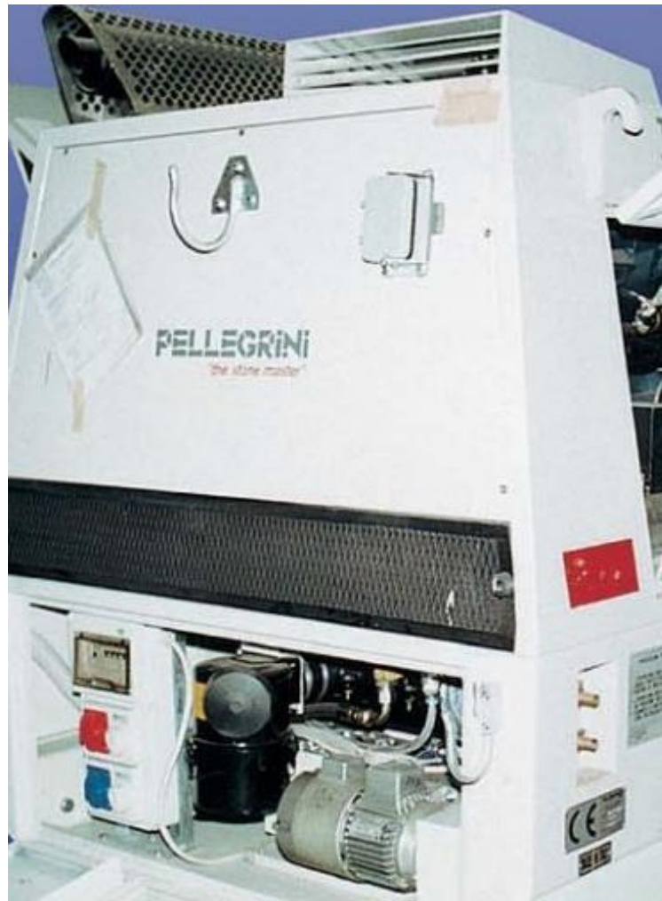
Slika 5.11. Sustav hlađenja i kućište
