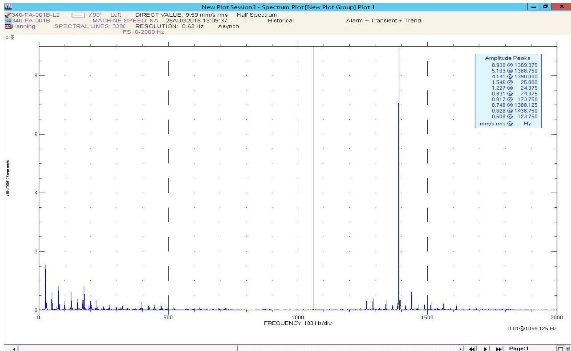
**Slika 5.6.** Frekvencijski spektar dobiven mjeranjem vibracija na motoru sa više radnih sati.
