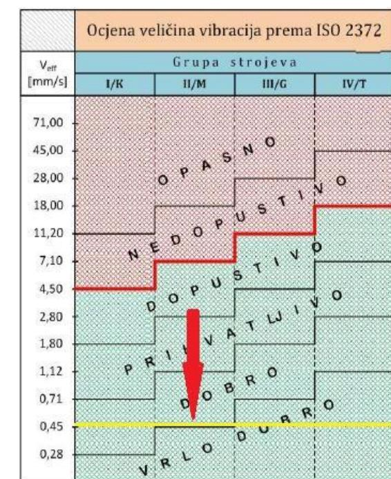
Slika 5.10. Prikaz stanja vibracija u stroju 2.
