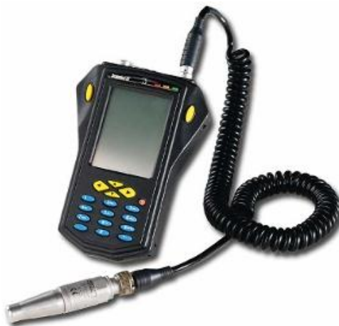
Slika 5.1. Bently Nevada Snapshot IS prijenosni sakupljač podataka
