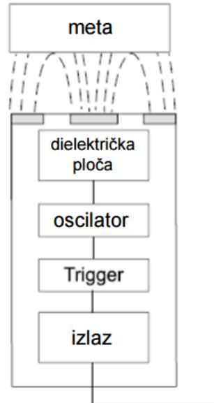
**Slika 3.6.** Kapacitivni senzor pomaka
