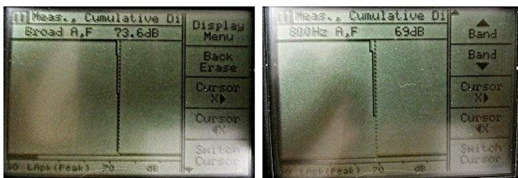
Prikaz razine zvuka asinkronog stroja sa spojenim istosmjernim strojem
