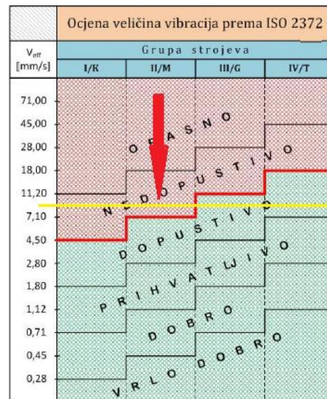
Slika 5.8. Prikaz stanja vibracija u stroju 1.
