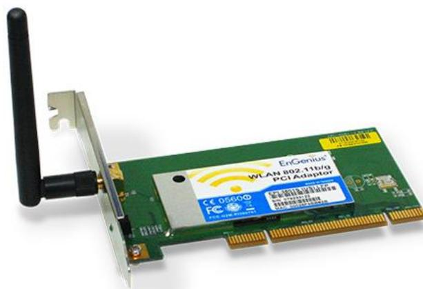
*Slika 3.7.4.1. prikazuje računalni modem bežični[15]*
