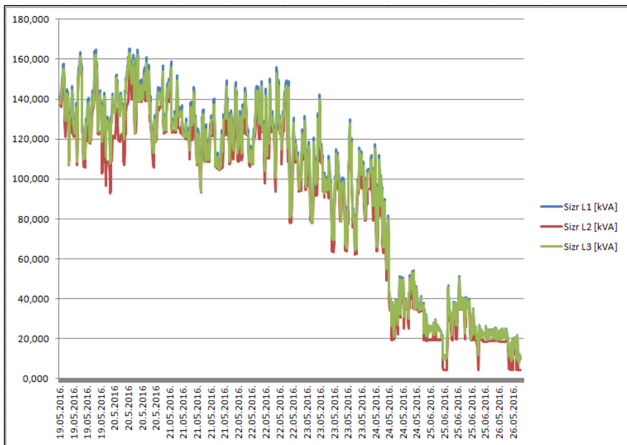
Slika 5.8. Graf mjerene vrijednosti prividne snage na polju kompenzacije
