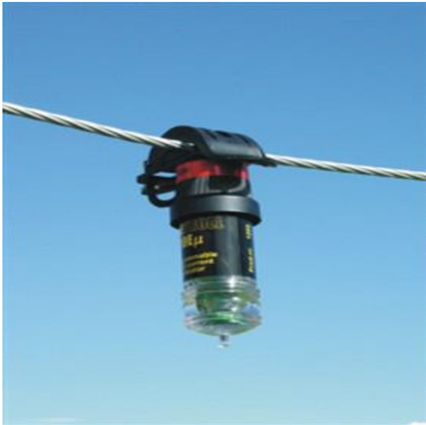
Slika 2.4. LineTroll 100E \mu indikator kvara [4]
