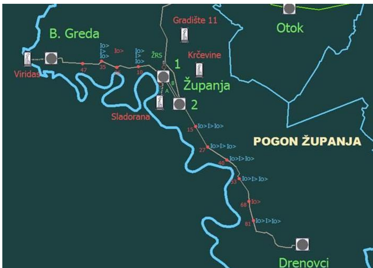
Slika 3.1. Indikatori kvara SIK-30 na 35 kV dalekovodima [13]
