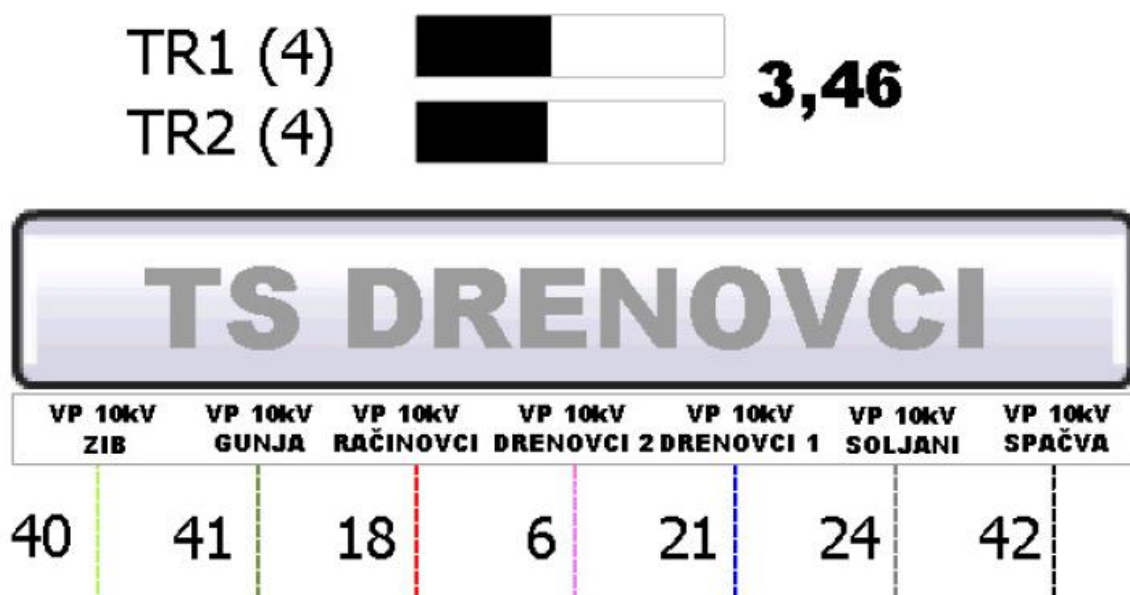
Slika 5.2. TS 35/10 Drenovci sa 10 kV vodnim poljima [11]
