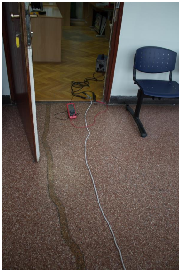
Slika 7.5. Simuliranje opterećenja nadžbukno postavljenog kabela
