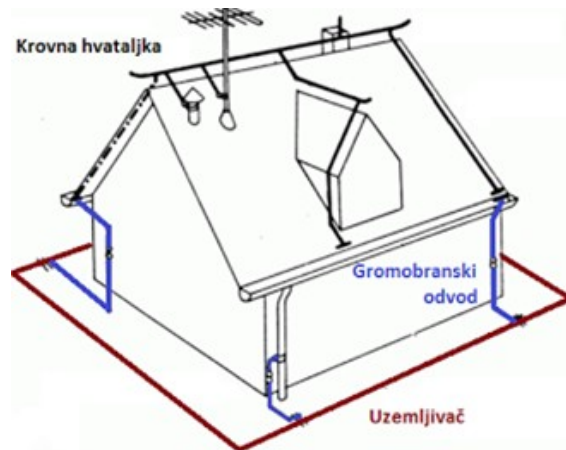
Slika 2.2. Izvedba gromobranskog uzemljenja na primjeru kuće
