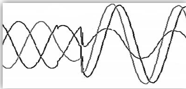
Slika 2.8. Nesimetrija napona prikzana u vremenskoj domeni.
