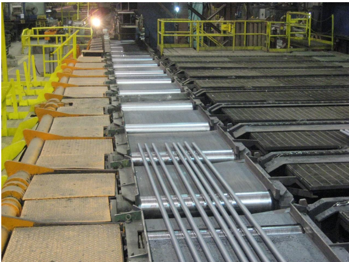
Sl. 1.1. Prikaz sustava transportnih valjaka
