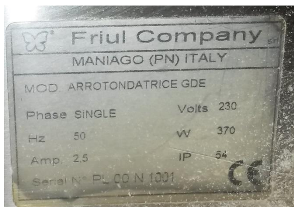
Slika 4.27. Natpisna pločica zaobljivača tijesta
