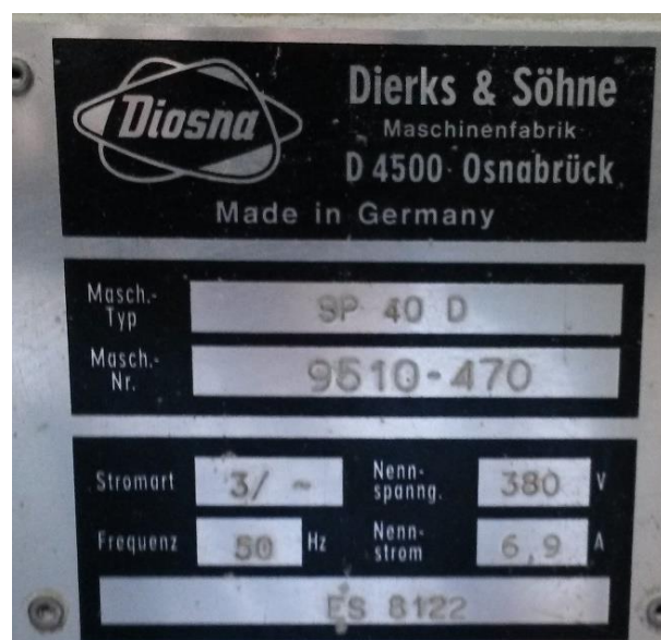
Slika 4.14. Natpisna pločica Diosna mjesilice
