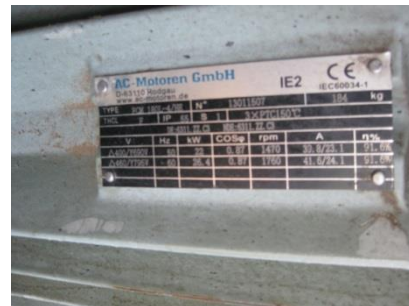
Slika 3.63. Pločica motora za usitnjavanje
