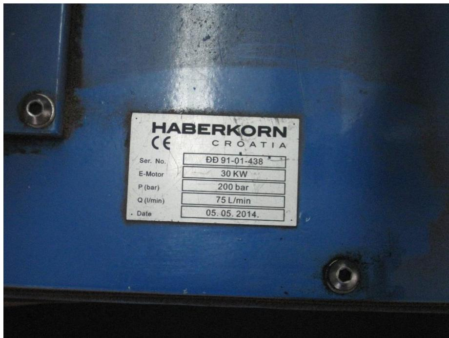
Slika 3.14. Nazvina pločica hidrauličke pumpe
