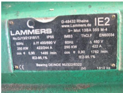
Slika 3.62. Pločica motora za usitnjavanje
