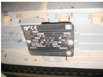
Slika 3.64. Pločica motora za pokretanje trake
