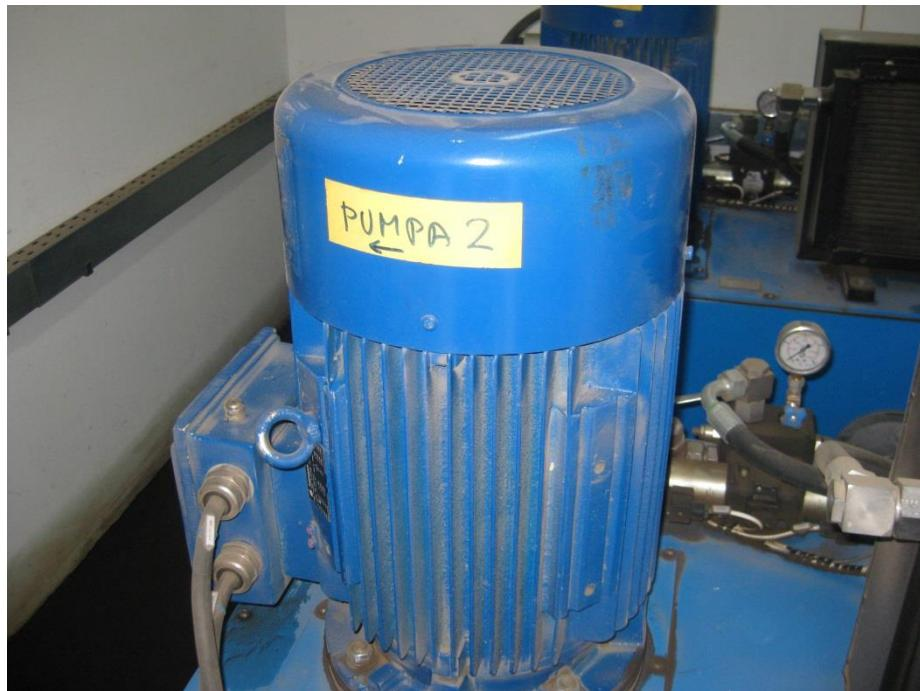
Slika 3.13. Hidraulička pumpa
