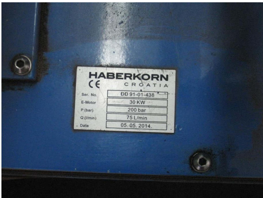
Slika 3.14. Nazvina pločica hidrauličke pumpe
